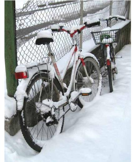
**Mach dein Fahrrad wintertauglich!** Alle Räder verlangen in der nasskalten Jahreszeit nach besonderer Pflege. Wer die Kette regelmäßig mit einem öligen Lappen sauberwischt, entfernt Salzreste und verhindert dadurch die Bildung von Rost. Weniger Reifendruck, breitere Reifen und Spikes erhöhen die Sicherheit auf nassen und glatten Straßen. Der Lauteracher Bauhof ist besonders bemüht die Radwege und Gehsteige schnee- und eisfrei zu machen.
